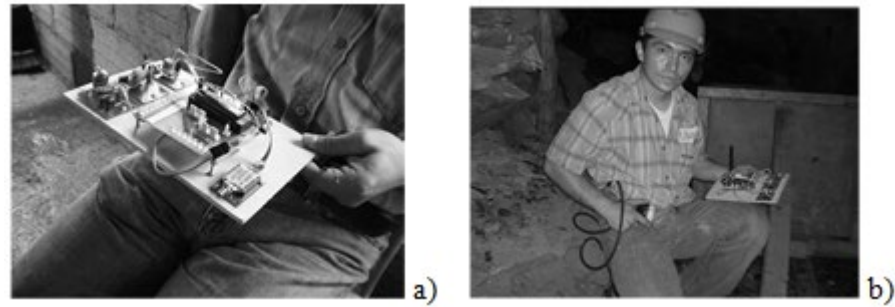
Figura 4. (a) Ejemplo del montaje de una tarjeta con sus componentes y (b) banco de pruebas realizadas al interior de una mina de carbón. Fuente: elaboración propia.
