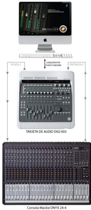
(b) Diagrama de conexión para la mesa de mezcla Onyx 24-4™
