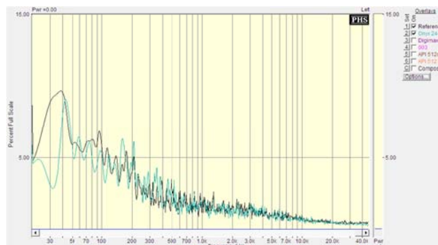
Fig. 7. Comparación del ancho de banda entre la ONYX 24-4 y la referencia
