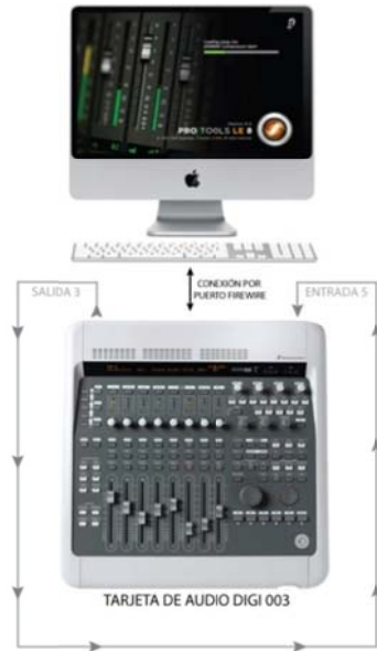
(a) Diagrama de conexión para el sistema 003™
