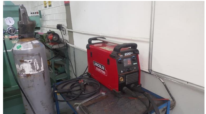
Figura 1. Máquina Lincoln Electric para soldadura GMAW
