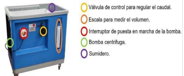
**Figura 2.** Banco Hidráulico Edibon. Fuente: Manual Turbina Pelton Edibon
