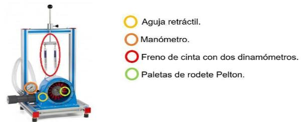
**Figura 1.** Turbina Pelton Edibon. Fuente: Manual Turbina Pelton Edibon
