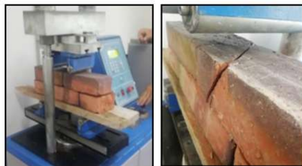
Figura 11. Ensayo de flexión aplicado a muro de ladrillos de arcilla convencionales
