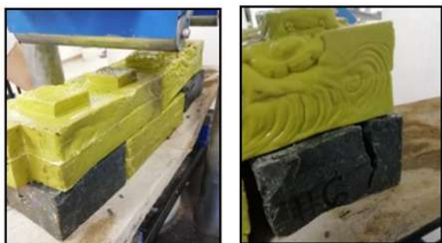
Figura 10. Ensayo de flexión aplicado a muro de ladrillos de plástico
