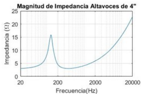
Figura 4. Curvas de impedancia promedio. (a) Magnitud de Impedancia para altavoces Peerless de 2" (b) Magnitud de Impedancia para altavoces DROK de 4"
