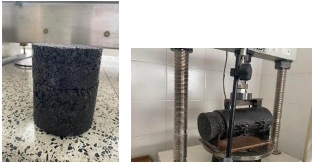
Figura 4. Registro Fotográfico capas adheridas y ensayo de corte
