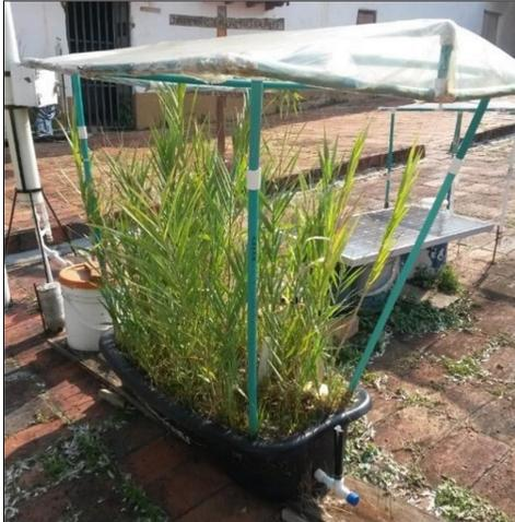
**Figura 4.** Humedal descarga cero con caña castilla
