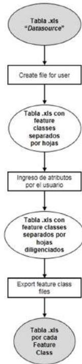
Figura 3. Esquema del procesamiento de la información geográfica usando el aplicativo Debug.
