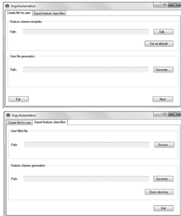
**Figura 2. Interfaz de usuario del aplicativo Debug. Arriba: Pestaña “Create file for user”. Abajo: Pestaña “Export feature class files”.**
