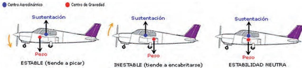
Figura 11. Estabilidad longitudinal en función del Centro de Gravedad y el Neutral Point. [13].
