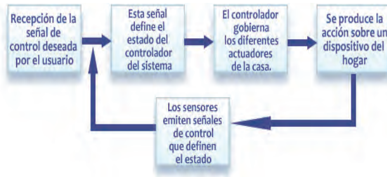
Figura 1. Diagrama de bloques de un sistema domótico básico. Fuente: Autores.
