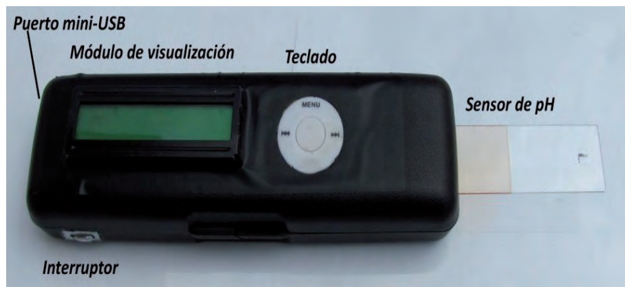
Figura 6. Resultado final del sistema optoelectrónico de medida de pH.
