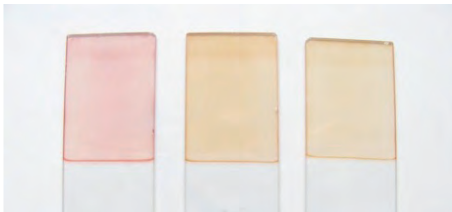
Figura 1. Sensores de pH preparados por Sol-Gel y depositados con la técnica de Dip-Coating.
