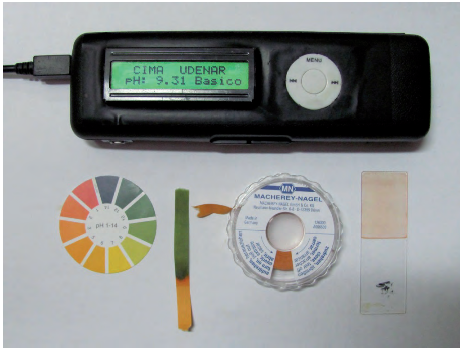
Figura 7. Comparación de resultados entre el sistema optoelectrónico de medida de pH y el papel indicador de pH.
