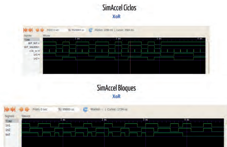
Fig. 11. Resultados de la verificación de la compuerta xor.
