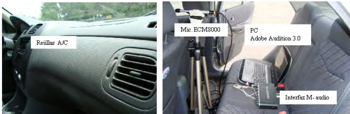
Figura 5. Estructura del sistema de medición para la caracterización de la fuente de ruido.
