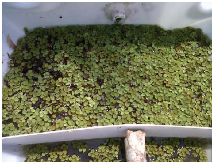
Figura 5. Descarga del agua residual en el piloto humedales artificiales de tipo superficial. Fuente: Quintero y García, 2012.
