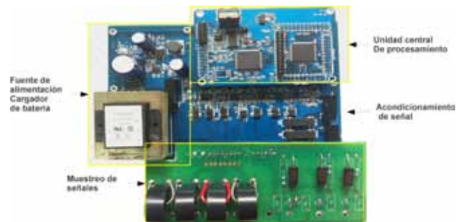
Figura 6. Sistema de medición de energía utilizando la arquitectura de tratamiento de señales discretas [24]
