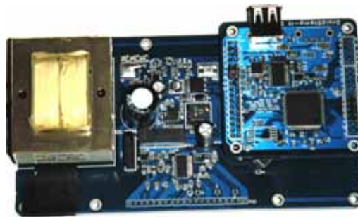
Figura 5. Sistema de medición de energía utilizando el ASIC MAXQ3183 [24]
