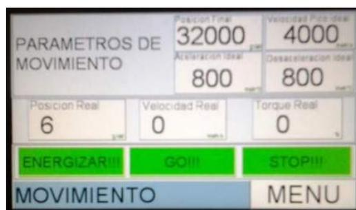
Fig. 8 Vista del HMI con los parámetros ajustables
