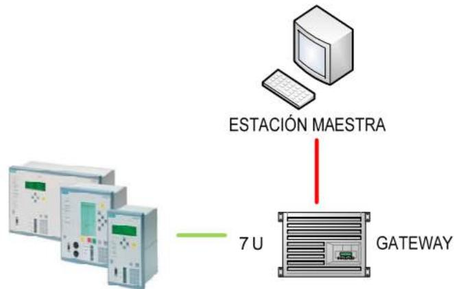
Fig. 1 Arquitectura de control y supervisión
