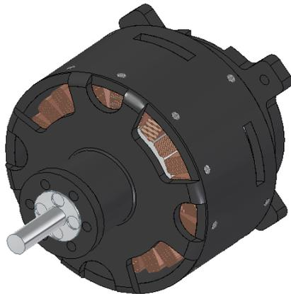
Figura 7. Motor eléctrico en CAD.
