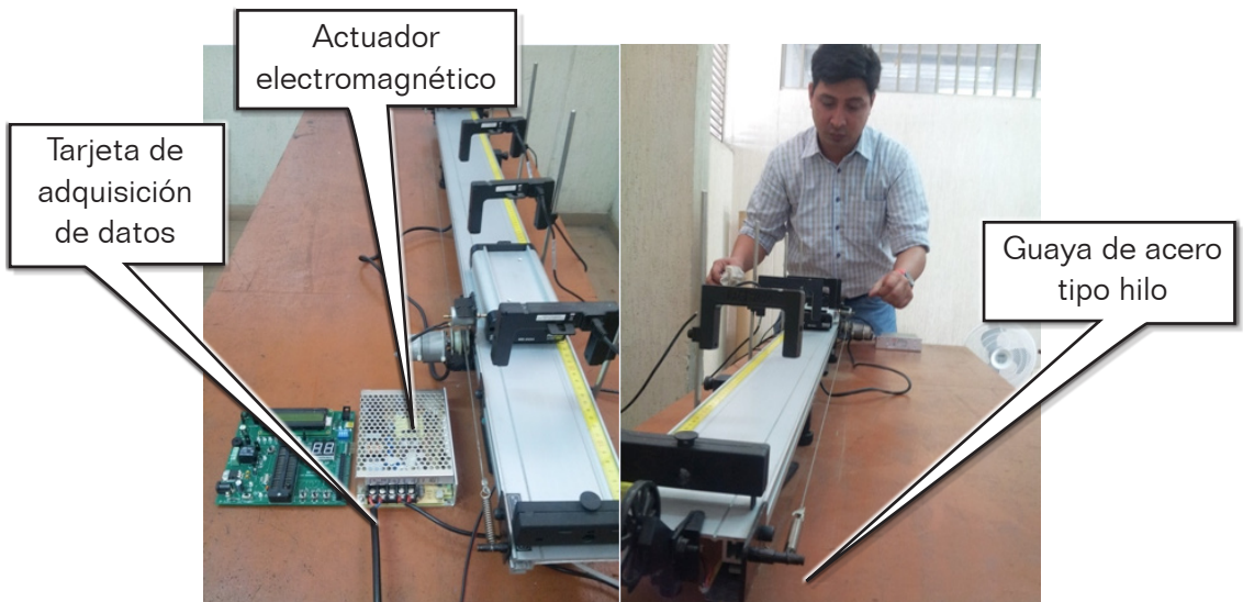
Figura 5. Sistema de acople mecánico. Laboratorio virtual-remoto
