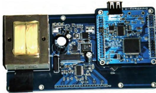
Figura 7: Sistema de medición de energía utilizando el ASIC MAXQ3183.
