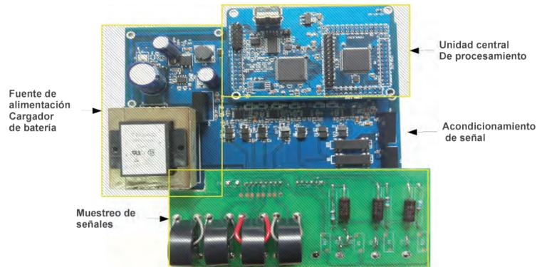
Figura 8: Sistema de medición de energía utilizando la arquitectura de tratamiento de señales discretas.
