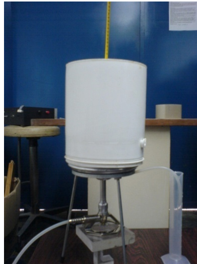
Figura 3. Sistema de calorimetría: Calorímetro tipo Junkers
