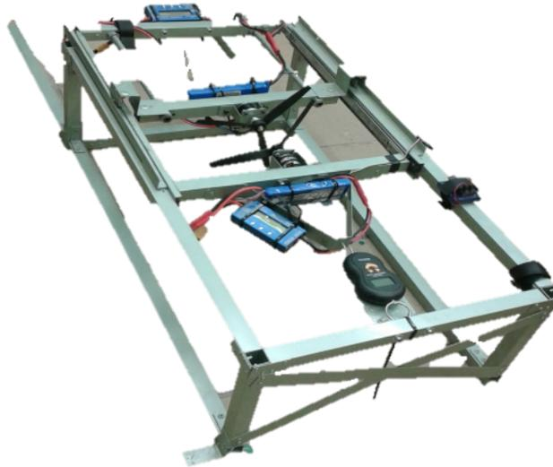
Figura 3. Montaje final banco de pruebas.
