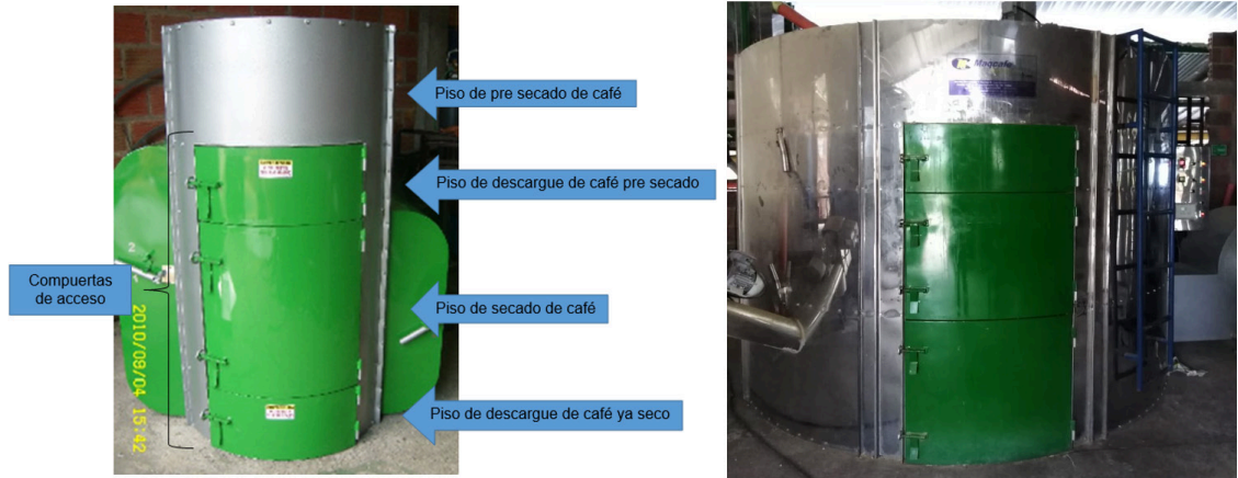
Figura 6. Secadora circular con rotación 100% funcionando en sus pisos de pre secado, descargue y secado en el silo
